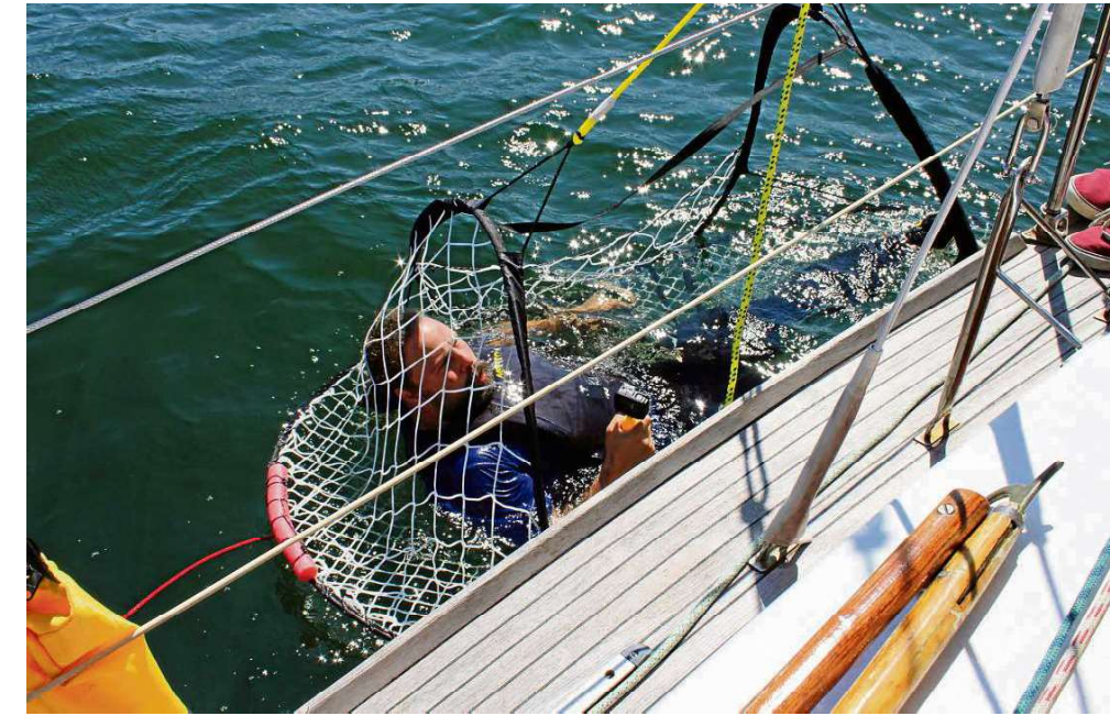
„Mensch über Bord – Gemeinsam gegen das Ertrinken“ hieß es im YCL. Verschiedene Mensch-über-Bord-Szenarien standen auf dem Programm. Hier ist das Pop-Net im Einsatz, ein selbst entfaltendes tunnelartiges Netz.
